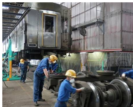
台車を外しての点検
