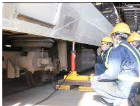
慎重に車輪をレールに戻します
