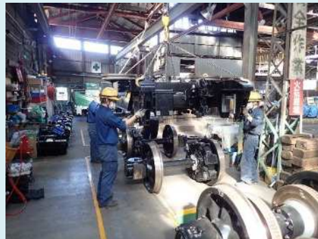
【台車組み立て作業】
